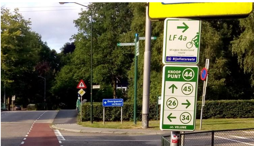
Rycina 26. Oznakowanie sieci węzłów regionalnych (znak na dole) dostosowanych do tras długodystansowych (znak na górze). LF4 (część EuroVelo 15) skręca w prawo w kierunku węzła 26, a następnie prowadzi tą samą trasą co połączenie węzłowe.
